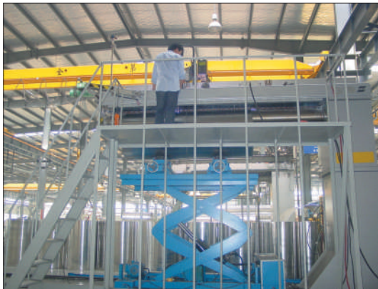
进口全自动纵缝焊接工作站(瑞典)
