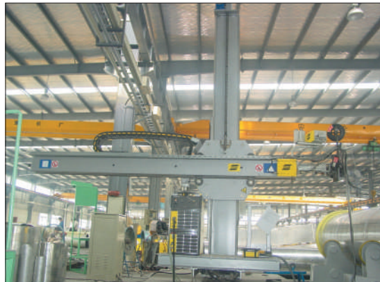
进口全自动环缝焊接工作站(瑞典)
