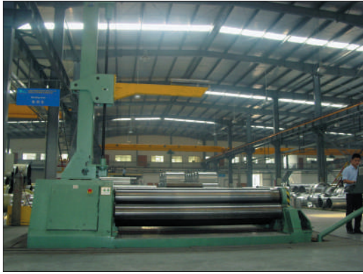
进口全自动微机控制4辊卷板机(瑞典)
